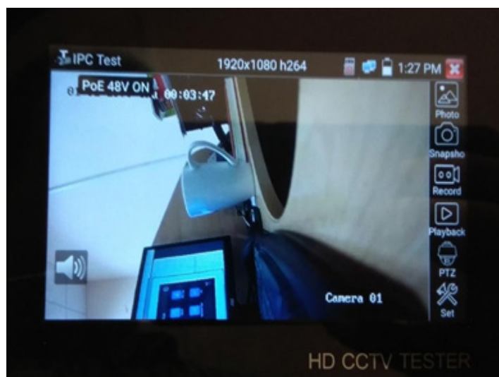
Рис. 17 Пример успешного подключения IP-видеокамеры к тестеру
