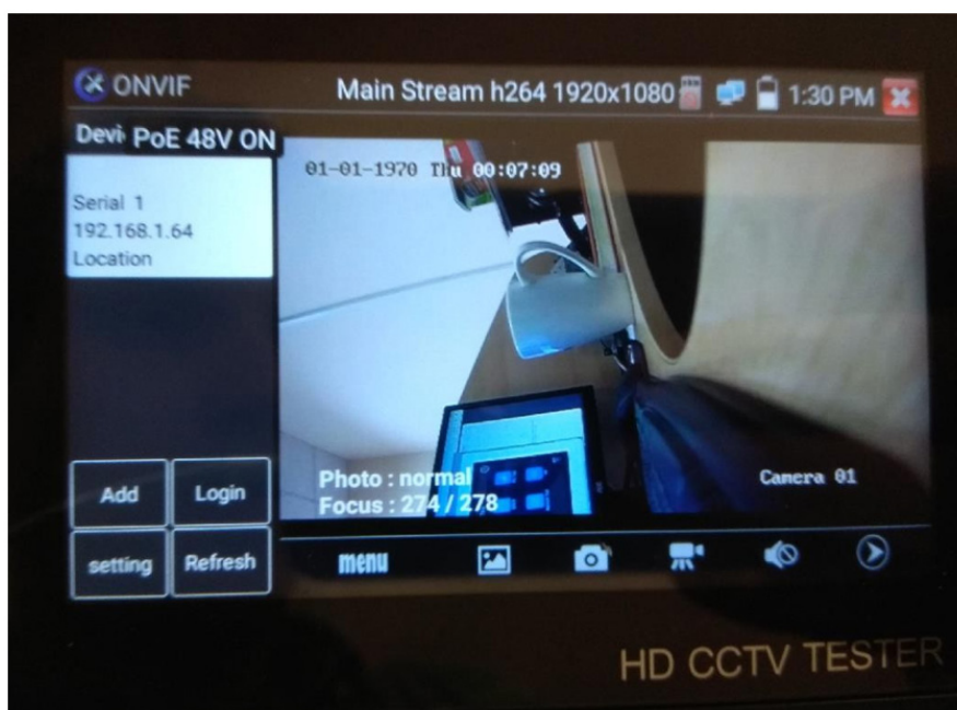
Рис. 18 Пример успешного подключения IP-видеокамеры к тестеру через Onvif
