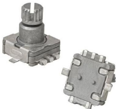
Энкодер инкрементальный двухканальный с переключателем RUICHI EC11E, 5 В, разрешение 30/15, длина вала 10 мм, SMD-корпус, положение вертикальное, металл - это устройство, предназначенное для преобразования угла поворота вращающегося объекта (вала) в цифровые или аналоговые сигналы, позволяющие определить угол его поворота.
